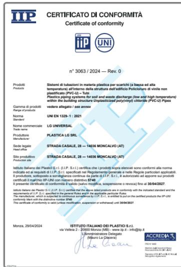
LG UNIVERSAL è un tubo in pvc a parete compatta con un contenuto di pvc superiore all'80% in massa per lo scarico di acque ad alta o bassa temperatura utilizzato sopra terra all'interno dei fabbricati o all'esterno. La temperatura massima permanente dei fluidi è di 70°C mentre per scarichi discontinui la temperatura è di 95°C.
